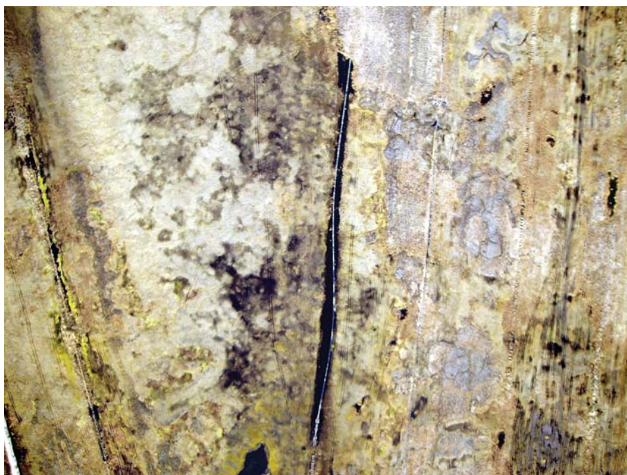
Рисунок 4. Участок трубы магистрального газопровода с обводнением и продольным сжатием
