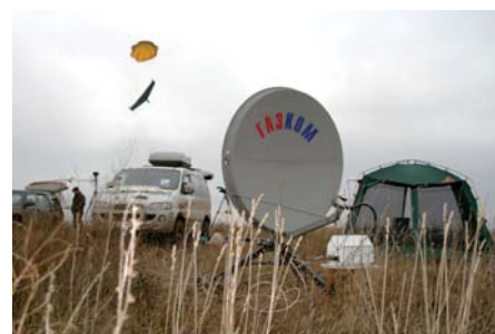
Рисунок 12. Беспилотный авиационный комплекс на базе автомобиля повышенной проходимости со средствами спутниковой связи и жизнеобеспечения
