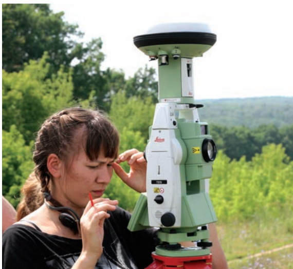
Рис. 8. Досъемка контурной части карты с использованием электронного тахеометра для автономного определения съемочных точек спутниковыми методами в режиме реального времени
