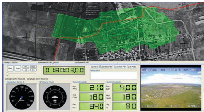
Рис. 2. Информация, отображаемая в видеоочках пилота-оператора [4]
